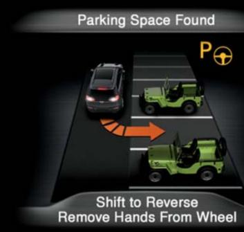
Le indicazioni del sistema di ausilio al parcheggio parallelo e perpendicolare ParkSense® sono visualizzate al centro del quadro strumenti e ti assistono durante il parcheggio.
