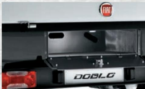
VANO ESTERNO PORTAOGGETTI CON SERRATURA PER RIPORE ATTREZZI FINO A 2 METRI DI LUNGHEZZA
