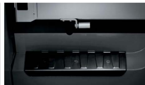
Vano esterno portaoggetti con serratura per riporre attrezzi fino a 2 metri di lunghezza
