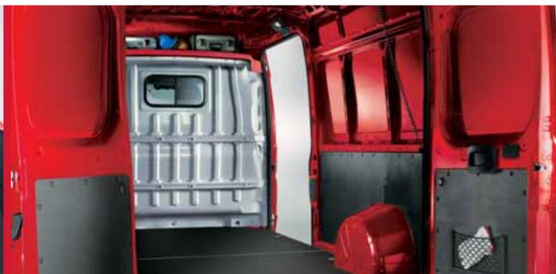
**Protezioni pareti vano di carico.** Anche le pareti del vano possono essere rivestite con pannelli di protezione in plastica. A richiesta sono disponibili pannelli a mezza altezza o fino al tetto H2.
