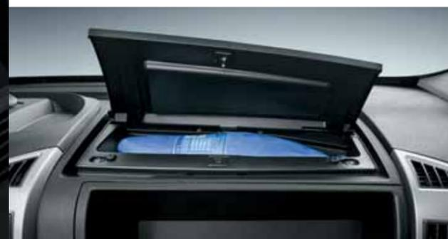
Il vano refrigerato mantiene freschi alimenti e bevande quando l'aria condizionata è in funzione.
